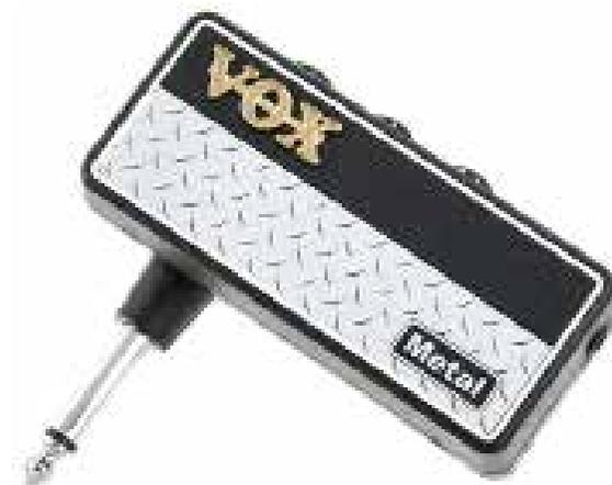
Con entrada jack de 6,3mm integrada para conexión directa de guitarra
