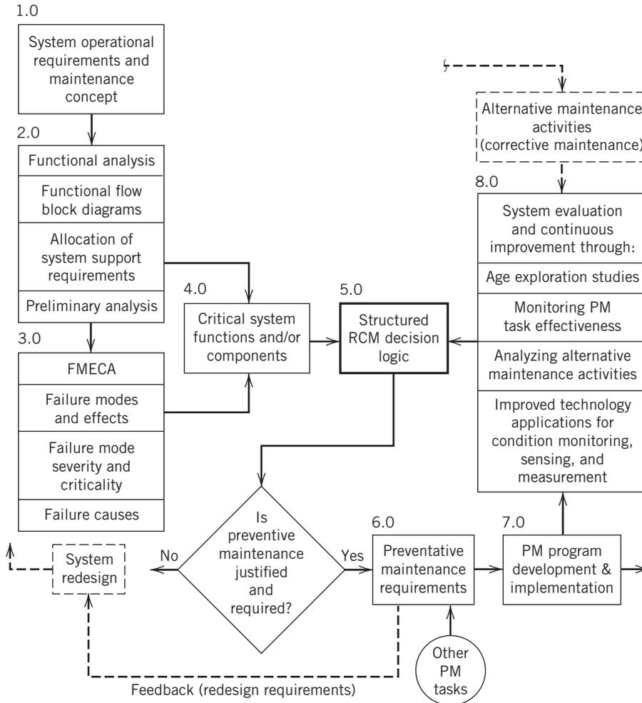
**FIGURE 1: RELIABILITY-CENTERED MAINTENANCE ANALYSIS PROCESS.**
