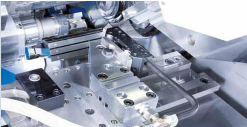
Caixa de acionamento com unidades de avanço hidráulicas de carro longitudinal e sistemas de medição lineares
