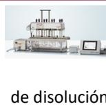
Un sistema de circuito cerrado. Todas las muestras se agregan simultáneamente. La solución se transfiere al espectrofotómetro UV/Vis y luego se devuelve al envase de disolución. El UV/Vis mide un solo punto o el espectro completo.
