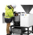
División exacta de grandes cantidades de muestra, hasta 60litros. Recogida de 1 fracción en operación continua con material sobrante. Con 6, 8 o 10 fracciones por lote. Tolva abatible. Alimentador ajustable de intensidad.
