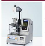
El instrumento determina automáticamente las características de flujo de polvo. Mide el tiempo de flujo, el ángulo del cono acumulado, peso, volumen y densidad de la muestra en el cono. Reporte en la impresora incorporada.
