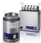
Los baños ultrasónicos Retsch limpian de manera intensa pero cuidadosa tamices analíticos, piezas de vidrio y metálicos. UR1 para 1 tamiz de 8", UR2 para 1 tamiz de 450mm, UR3 para 5 tamices de 8" de diámetro.
