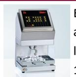
Este instrumento mide la fuerza necesaria para romper las ampollas de vidrio, para control de calidad antes de usarlas en la producción. Según la norma EN ISO <9187-1/2:2010>
