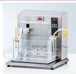
Desintegración y test de penetración de supositorios
