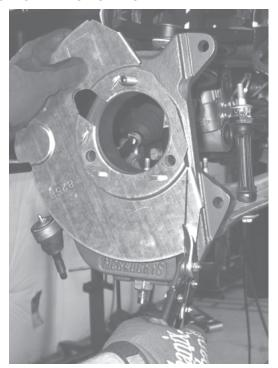
10. CUT OFF THE EXCESS TOP BALL JOINT STUD FLUSH WITH THE NEW NUT (ONLY NECESSARY ON 4WD)
