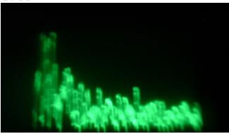
$_{\oplus}$   $_{/\!\!/}$   $_{\oplus}$  PHOTO No.27TUBE "D" ECHOES SHOWED MODERATE FAILURE
