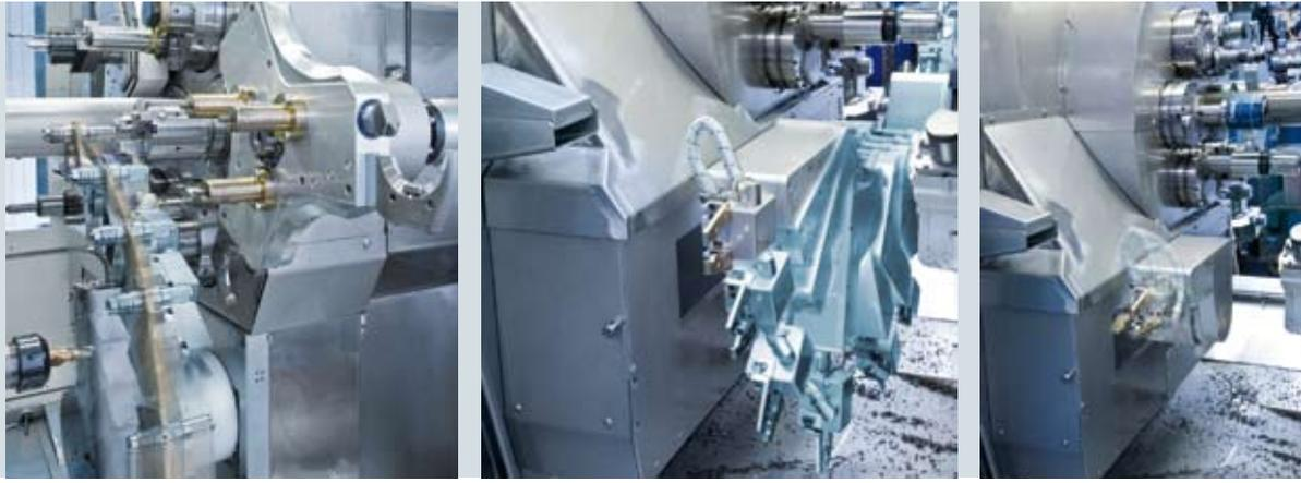
O manuseio da peça a partir da máquina até o pallette - uma concepção inteligente para evitar danos nas peças. Também é possível a separação automática para permitir a medição da peça, inclusive medições durante a usinagem.
