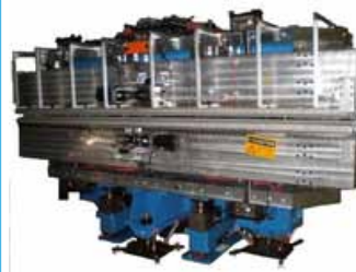
NSRRC 4 Meter EPU
