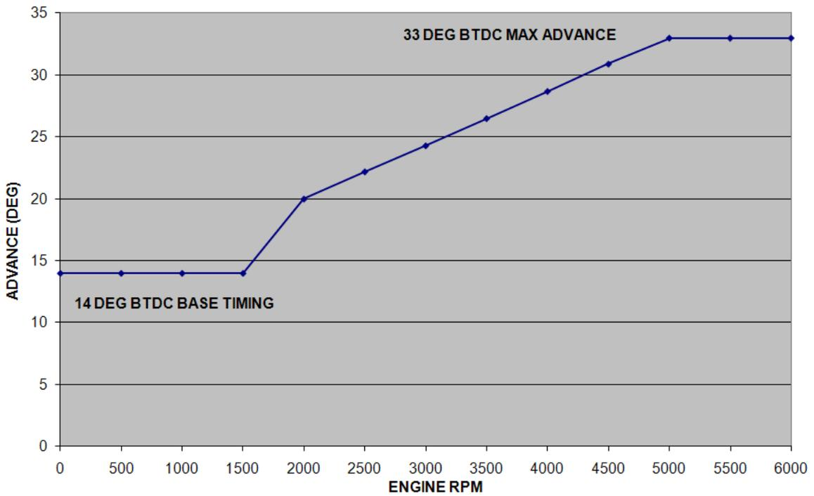
**MERCURY HP800SC TIMING CURVE**
