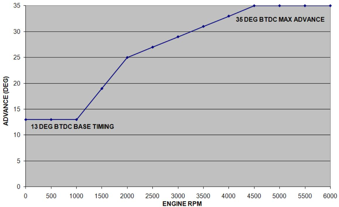
**MERCURY HP600SC TIMING CURVE**
