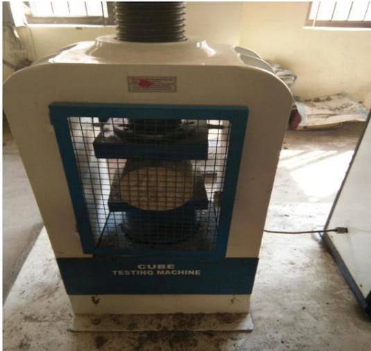
Fig No: 3 Split Tensile set up
