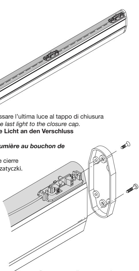
Dopo aver collegato tutte le luci in serie, infilarle nel profilo in gomma utilizzando, se necessario, una guaina passa-cavo.
