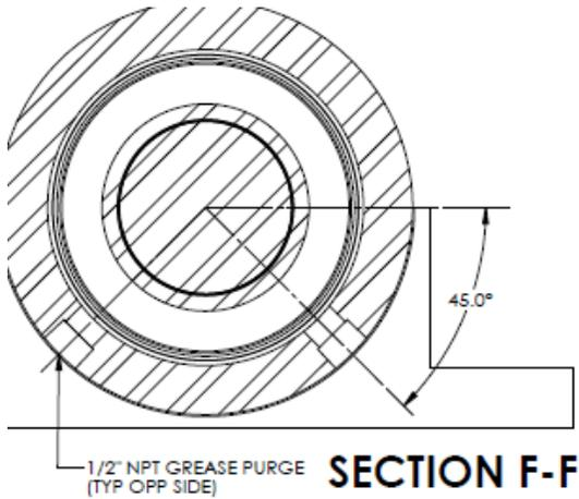
**Figure 23. End Cap Grease Purge Holes.**
