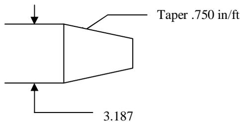
**Figure 28. Shaft Taper Fit Dimensions**
