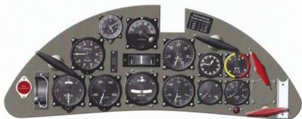
Henschel Hs 126 B-1 instrument panel. Drawing Dariusz Karnas.
