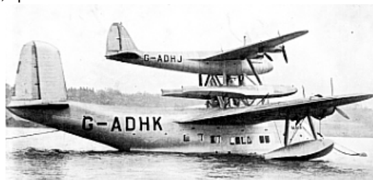
Le "Short-Mayo Composit" conçu par le Major R. M. Mayo d'Imperial Airways. L'avion principal "Maia" transportait le plus petit Mercury.
