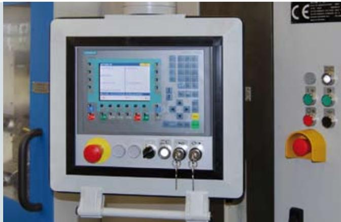
Painel de comando basculante para os dois lados da máquina
