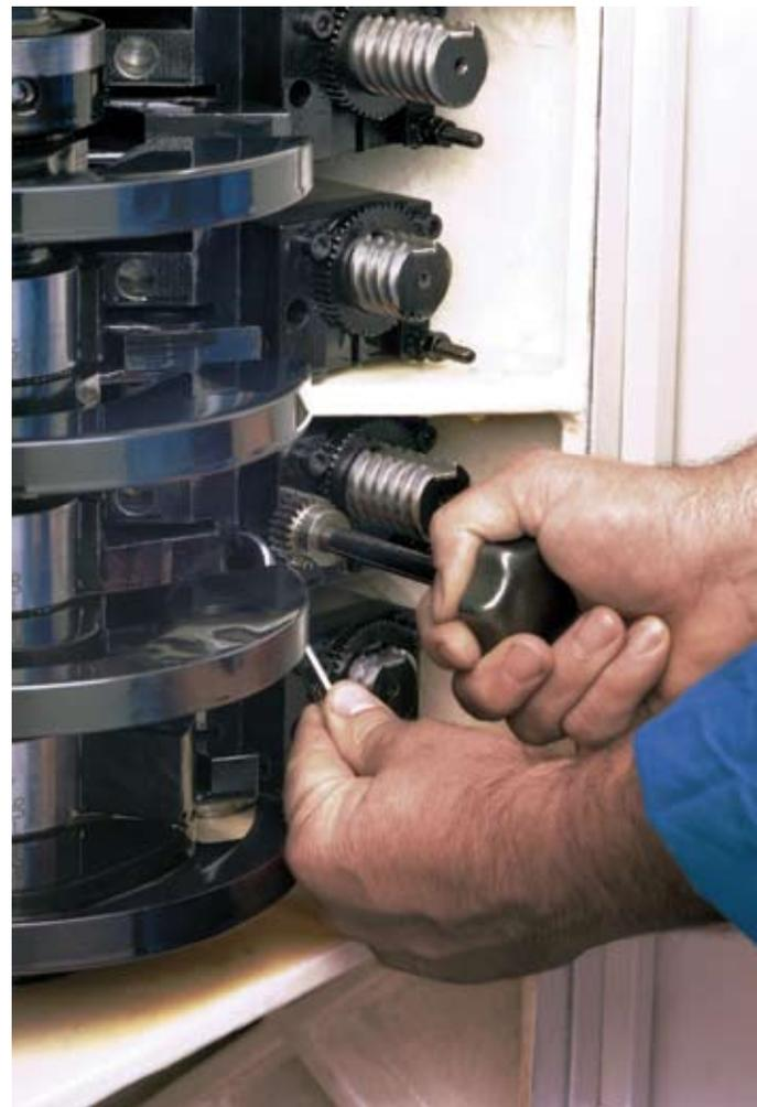
Ajuste de uma alavanca de carro longitudinal – ajustável sem escalonamentos e de fácil acesso
