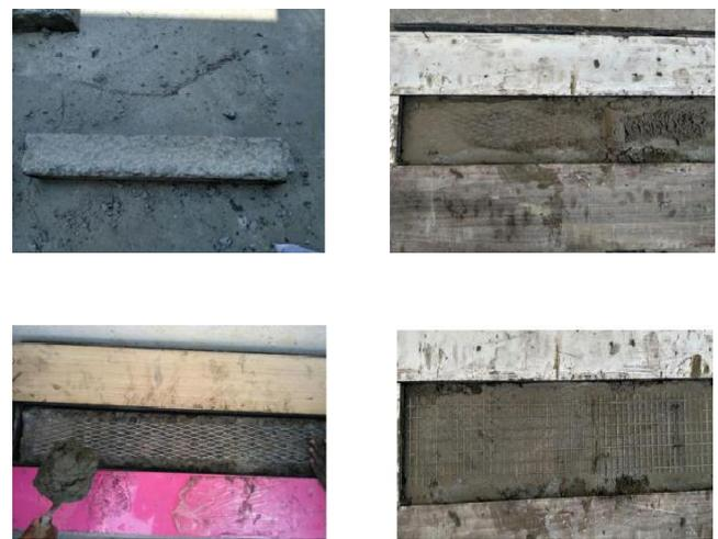
Fig 5.1 Retrofitted Beams: A) Chipped Beam B) SIMCON Laminate C) Expanded Metal Mesh D) Square Metal Mesh
