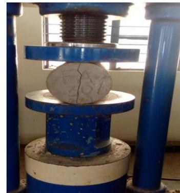
Fig 5.3 Split Tensile Test
