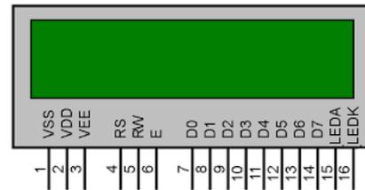
Fig. 6: LCD module
