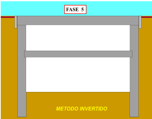
Fases constructivas típicas del método invertido utilizado para construir estructuras subterráneas mediante el uso de muros colados para sostener y contener las paredes perimetrales de la estructura
