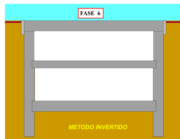
Fases constructivas típicas del método invertido utilizado para construir estructuras subterráneas mediante el uso de muros colados para sostener y contener las paredes perimetrales de la estructura
