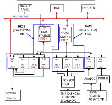
PANEL CONFIGURATION OF TURBINE CONTROL & PROT
