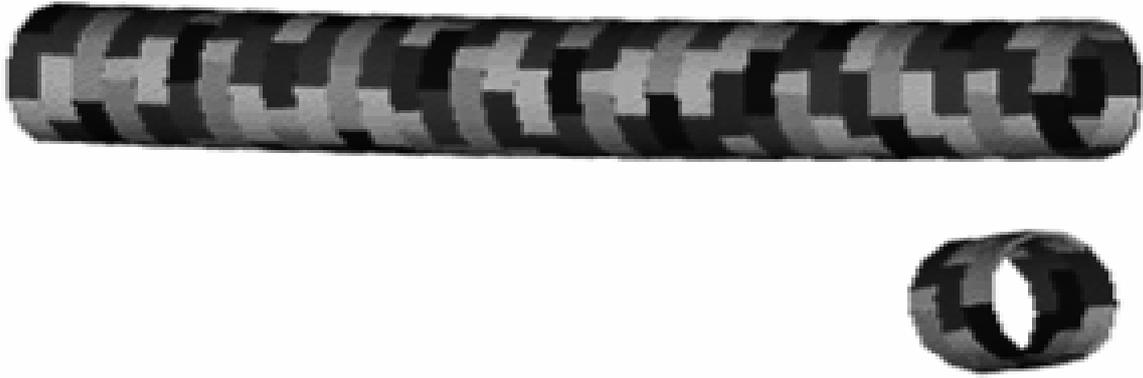
*Figura 4: Esquema la secuencia de anillos universales en curva de radio mínimo ( $R=300m$ )*
