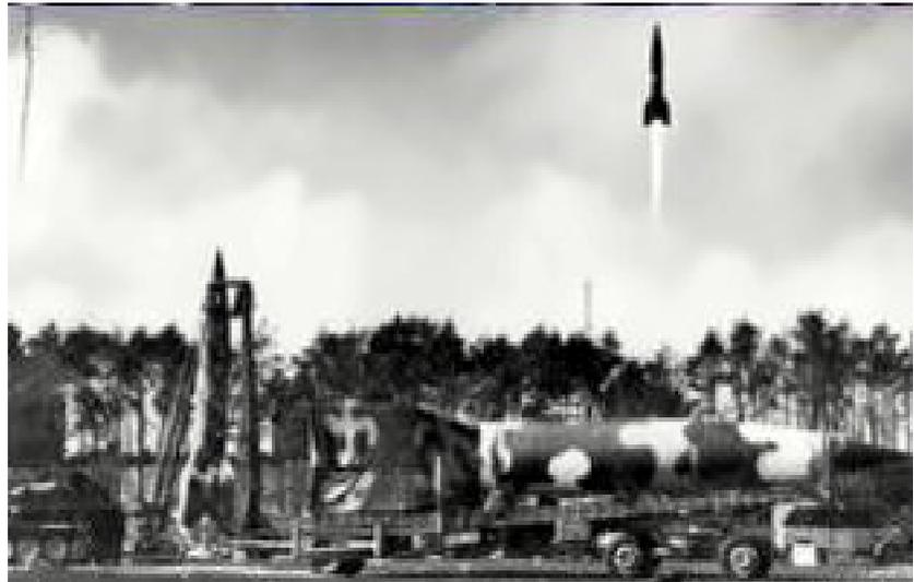
La fusée V-2 de 14 m est propulsée à l'alcool et à l'oxygène liquide à une altitude de 90 km à une vitesse de 5 400 km/h avec une autonomie de 320 km et une charge de 740 kg. Toutes les fusées modernes, y compris la fusée lunaire Saturn V, sont basées sur le concept A4.
