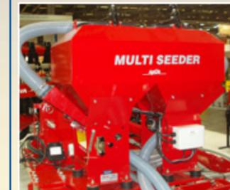
La sembradora Multi-Seeder Twin trae un tanque con dos espacios (2x100 l) y dos unidades de dosificación que hace posible ajustar por separado la cantidad de semillas. La Multi-Seeder Twin es por tanto ideal para la siembra de colza y la aplicación simultánea de productos contra babosas y caracoles. La Multi-Seeder Twin tiene como equipo estándar el Auto-Controller así como un ordenador, y ambos controlan las unidades de dosificación.
