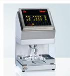
Este instrumento mide la fuerza necesaria para romper las ampollas de vidrio, para control de calidad antes de usarlas en la producción. Según la norma EN ISO <9187-1/2:2010>
