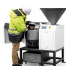
División exacta de grandes cantidades de muestra, hasta 60litros. Recogida de 1 fracción en operación continua con material sobrante. Con 6, 8 o 10 fracciones por lote. Tolva abatible. Alimentador ajustable de intensidad.
