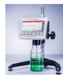
Viscosímetros rotativos con amplio rango de medición de 1 mPa·s hasta 600M mPa·s. 3 juegos de cuerpos de medición disponible para todos los rangos de viscosidad. Para alimentos, farmacéuticos, químicos.
