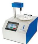
Instrumento automático con cambiador de muestras de 10 posiciones para la determinación rápida y confiable del punto de congelación de leche.
