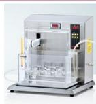
Instrumentos para medir el tiempo de desintegración de supositorios, pesarios y cremas a una temperatura fija. Celda de disolución para estudio de liberación de fármaco de supositorios.
