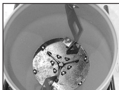
Step 15 • Paso 15 • Étape 15 Attach upper part of blade with nuts and bolts • Fije la parte superior de la cuchilla con tornillos y tuercas • Fixez la partie supérieure de la lame avec les écrous et les boulons
