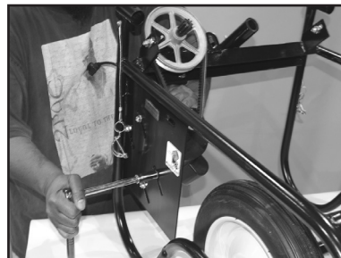
Step 7 • Paso 7 • Étape 7 Adjust the motor so the belt is tight • Ajuste el motor para que la banda esté tensa • Réglez le moteur jusqu'à ce que la courroie soit serrée
