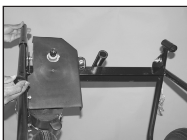
Step 18 • Paso 18 • Étape 18 Slide the pin through the holes • Deslice la chaveta a través de los agujeros • Passez la goupille par les trous
