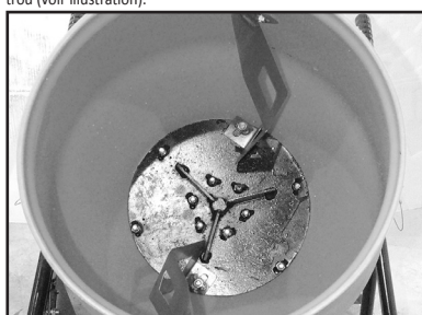
Step 14 • Paso 14 • Étape 14 Install mixer blades in the bottom of the drum with welded on nuts • Instale las cuchillas de la mezcladora en el fondo del tambor con las tuercas soldadas • Installez les lames du mélangeur au fond du tambour avec les écrous soudés.
