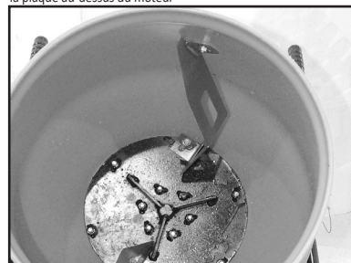
Step 12 • Paso 12 • Étape 12 Put the shaft through the hole in the drum. Turn drum until the holes line up • Ponga el eje a través del agujero del tambor. Gire el tambor hasta alinear los agujeros • Passez l'arbre par le trou situé dans le tambour. Tournez le tambour jusqu'à ce que les trous coincident
