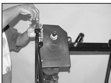
Step 17 • Paso 17 • Étape 17 Slide handle in place lining up the hole in the handle and the housing • Deslice el asa en su lugar, alineando el agujero del mango con el del gabinete • Installez la poignée en alignant le trou situé dans la poignée et le carter
