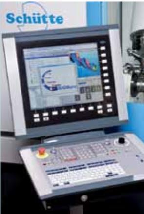
Console de comando da Schütte de 19" giratório, com interface do usuário do SIGSpro para controle total dos dispositivos e processo
