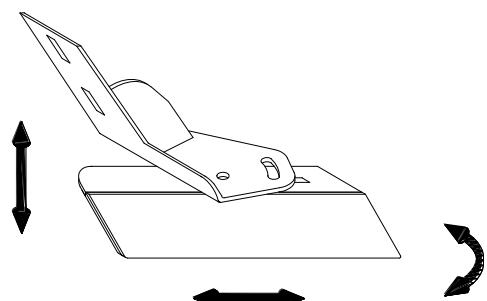
El equipo de borde (2) se ajusta de tal manera que el material sea colocado en "las ranuras" formadas por el disco trasero.
