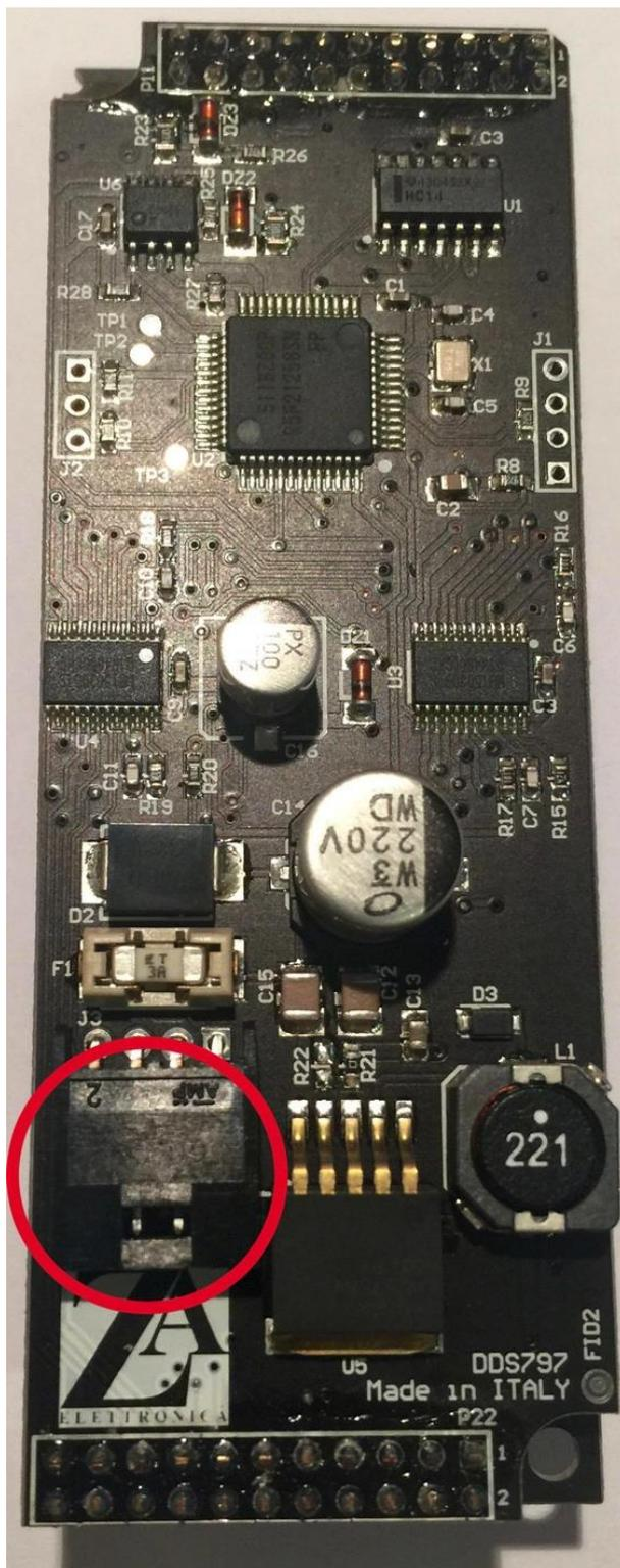
Una volta individuato il connettore sullo switchpod, inserire il cavo in dotazione nel connettore, come da foto:
