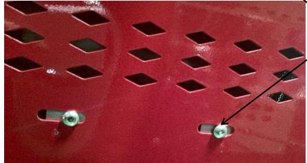
拆下发热丝盒在两边 侧板的固定螺丝
