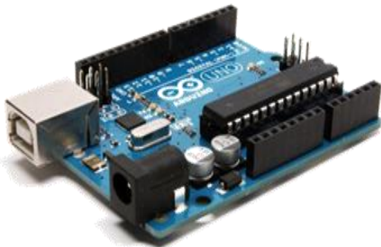
Fig.5 Arduino UNO R3
