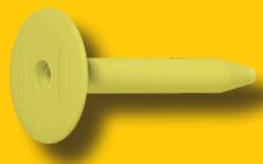
TERMOFIX es un sistema de fijación telescopico para la fijación de las membranas de impermeabilización y aislamiento térmico, en combinación con gama de tornillería que se ha de seleccionar en función del tipo de material base del soporte, chapa trapezoidal, madera u hormigón.
