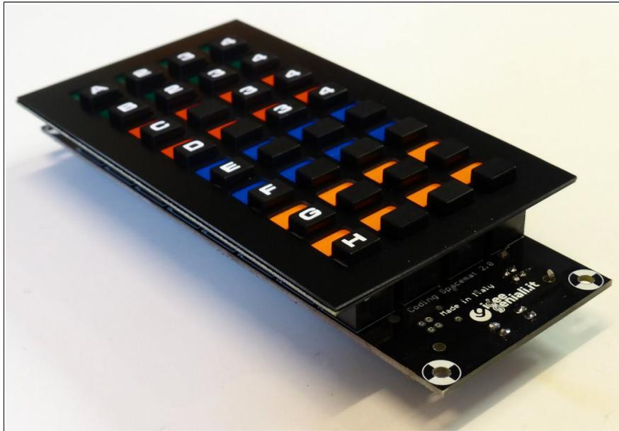
La coding spacemat è dotata di 32 tasti realmente funzionanti e un connettore USB-B. Il dispositivo è autoalimentato da porta USB. Collegare tramite cavo usb A/B (venduto separatamente) ad un PC. La tastiera viene riconosciuta automaticamente entro pochi secondi, senza caricare driver specifici in tutti i sistemi operativi: Windows, Linux, Mac, Android.
