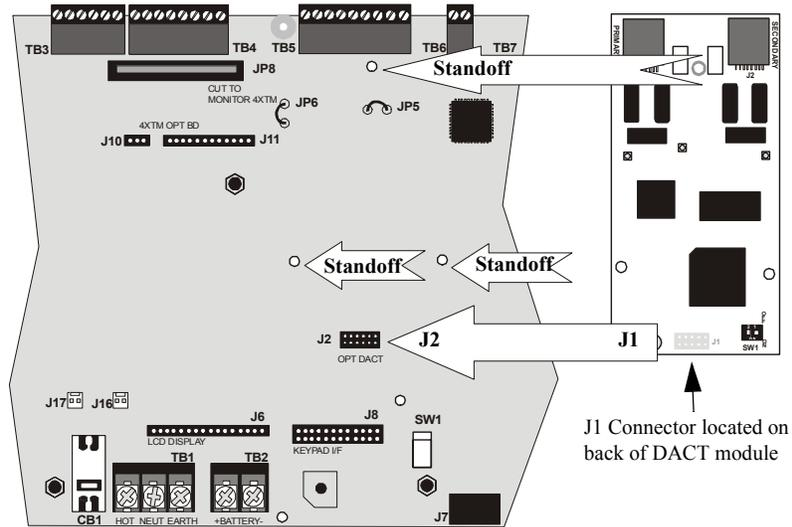
**Figure 2.12 DACT J1 Connector to FACP J2 Connector**
