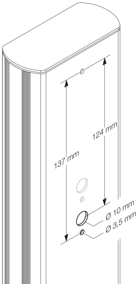
L'art. COL.P presenta delle forature predisposte per l'installazione della fotocellula PUPILLA. Nel caso si volesse utilizzare COL.P per l'installazione della fotocellula PUPILLA.B è necessario eseguire altri due fori come indicato in Figura.
