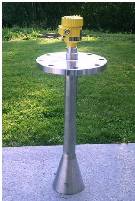
Transmisor de nivel de microondas montado
