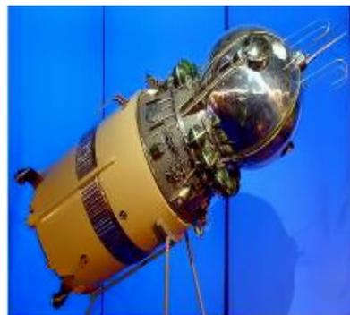
Корабль состоял из сферического спускаемого (Диаметр 2,3 метра, масса 2,46 т) , В котором разместился космонавт, приборы, система эвакуации, & конический модуль прибора (масса
