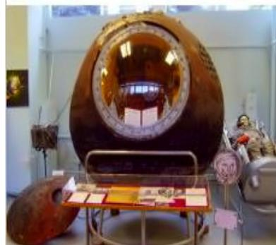
2,27 тонн, длина 2,25 м, 2,43 м в ширину) , Проведение пропеллент и система двигателя. На входе в атмосферу, космонавт выбрасывались из корабля примерно 7000 м спуск по парашюта. Капсула приземлилась бы отдельно.
