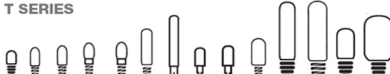
T3 T4 T4½ T5 T5½ T6 T6½ T7 T7½ T8 T9 T10 T14 T20
