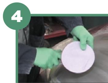
4 Efectuar el lijado del primer comenzando con la lija P320 con ayuda de un taco, en movimientos orientados.
