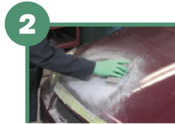
2 Efectuar el lijado del primer comenzando con la lija P320 con ayuda de un taco, en movimientos orientados.
