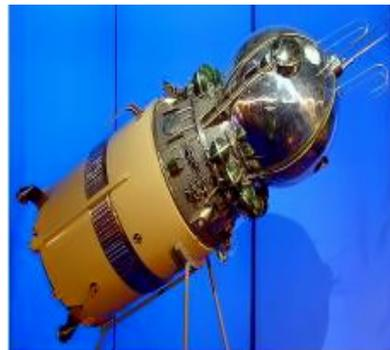
Das Handwerk bestand aus einem kugelförmigen Abstiegsmodul (Durchmesser 2,3 Meter, Masse 2,46 Tonnen), die ein untergebracht cosmonaut, Instrumente, Rettungssystem, und ein konisches Instrumentenmodul (Masse
