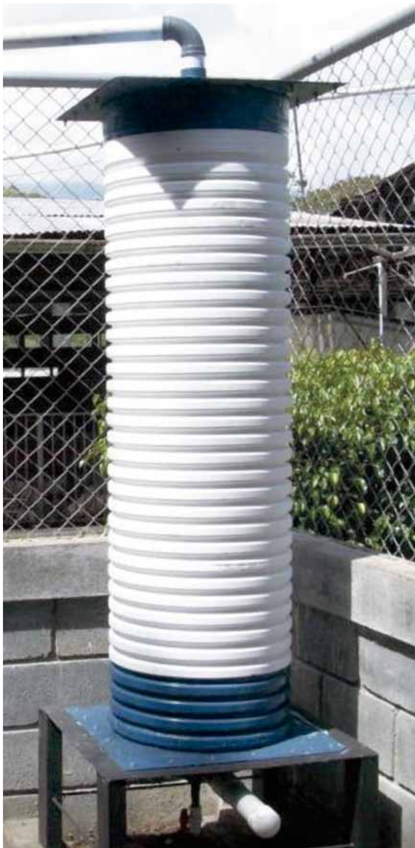
Figura 6. Filtro para remoción de H_2S en biogás marca Viogaz.
