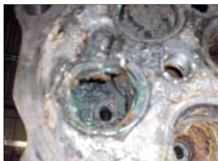
Figura 2. Daño provocado por H 2 S en un motor de combustión interna.
