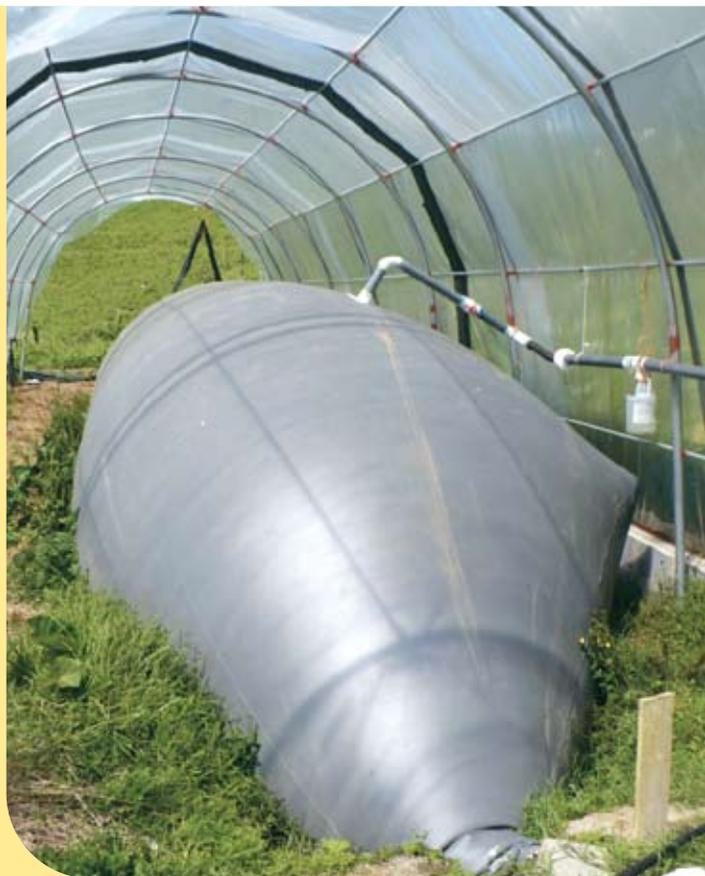
Biodigestor tubular de PVC.
