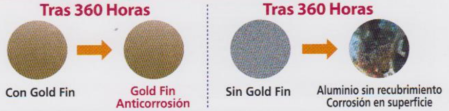
Resultado de Prueba de Sal Spray : 360 horas [Test Standard : KS D 9502, ASTM]
