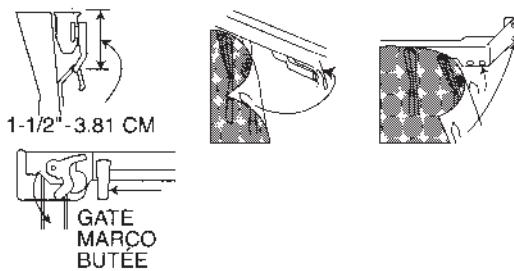
CHANGE A 2-WAY ROD TO A 1-WAY ROD • CONVERTIR LA BARRA DE TRACCION DOBLE EN UNA BARRA DE TRACCION UNILATERAL • CHANGEMENT DU TIRAGE À DEUX SENS AU TIRAGE À UN SENS
