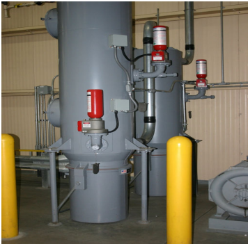
Patlama güvenlik sistemi ile donatılmış siklon
