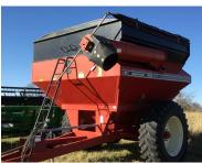
Unverferth 4500 550 bu grain cart, 1000 pto, side auger
