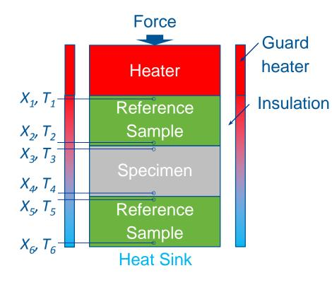
$$\kappa = \frac{X_4 - X_3}{T_4 - T_3} \cdot \frac{\kappa_{ref}}{2} \cdot \left(\frac{T_2 - T_1}{X_2 - X_1} + \frac{T_6 - T_5}{X_6 - X_5}\right)$$
