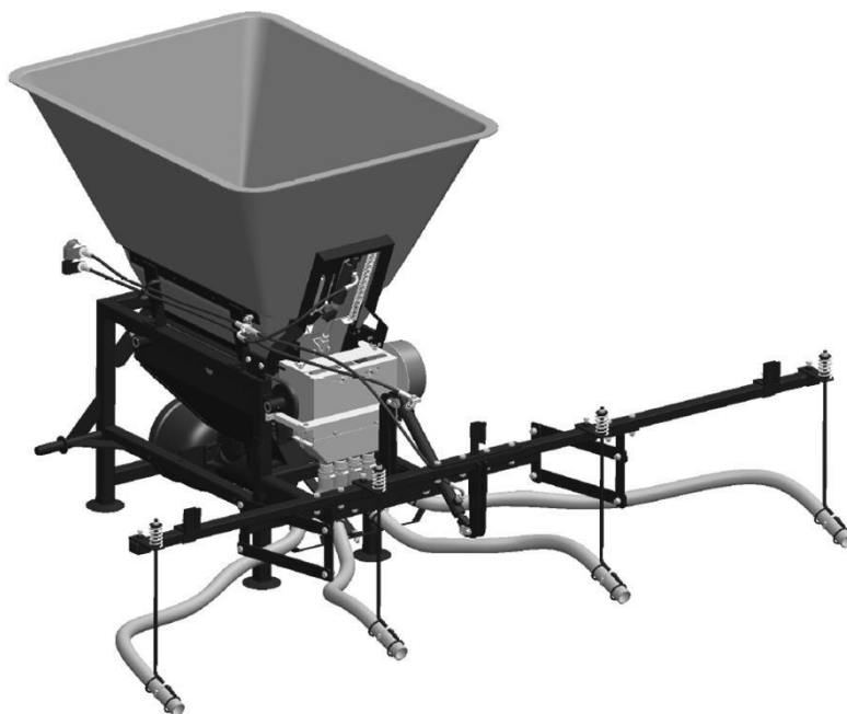
Figura. 11. Esparcidor de fertilizante N031M/1 con el esparcidor de hileras.
