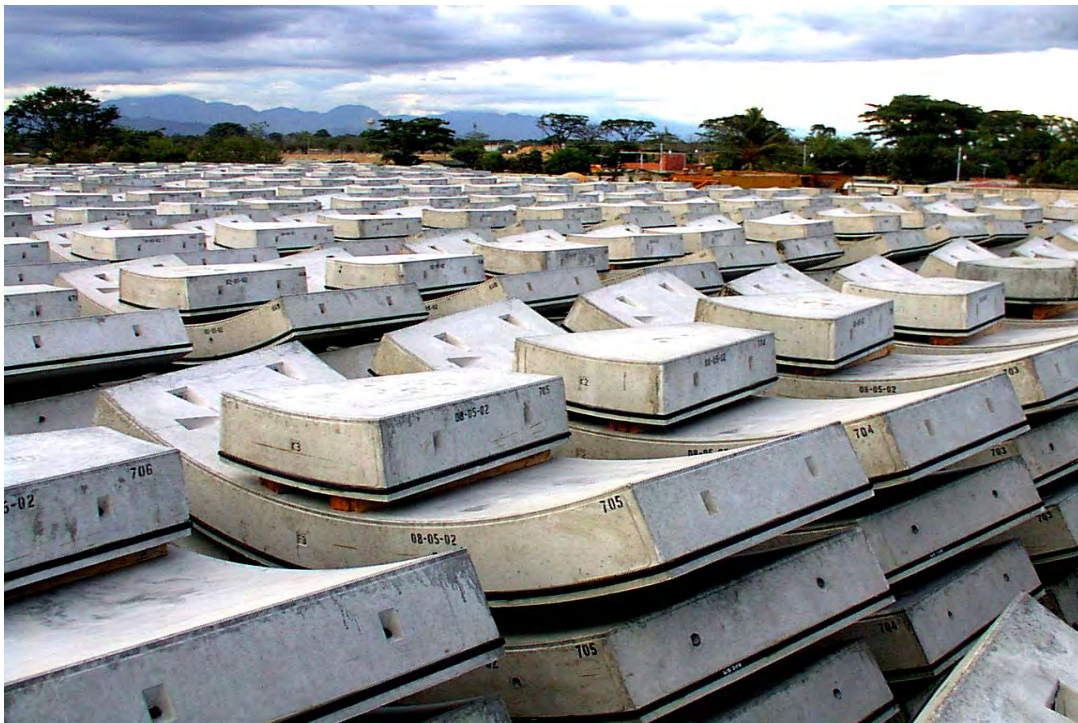
Metro de Valencia – Segmentos de los anillos de revestimiento prefabricados
