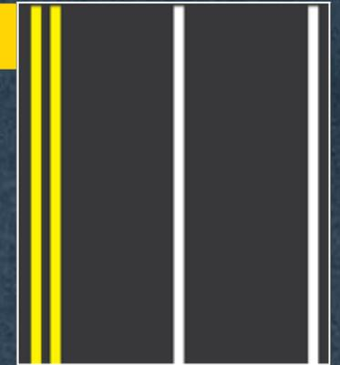
Las líneas blancas continuas, se usan en los carriles para dar vuelta y para prevenir que los vehículos cambien de carriles cerca de las intersecciones. Las flechas, se usan con frecuencia con las líneas blancas para indicar en qué dirección se puede dar vuelta desde ese carril.
