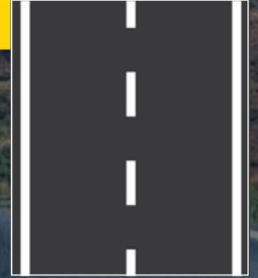
Las líneas blancas entrecortadas, separan los carriles del tráfico que circula en la misma dirección. Estas líneas se pueden cruzar con precaución. Recuerde que debe señalar, con la direccional o con la mano, para indicar su intención de cambiar de carriles.
