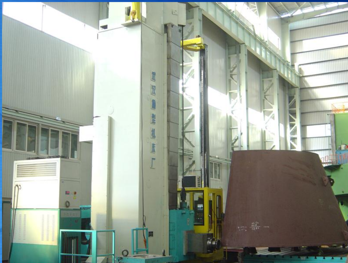
数控落地铣镗床 FB225/2配TDV80/2数控回转工作台
