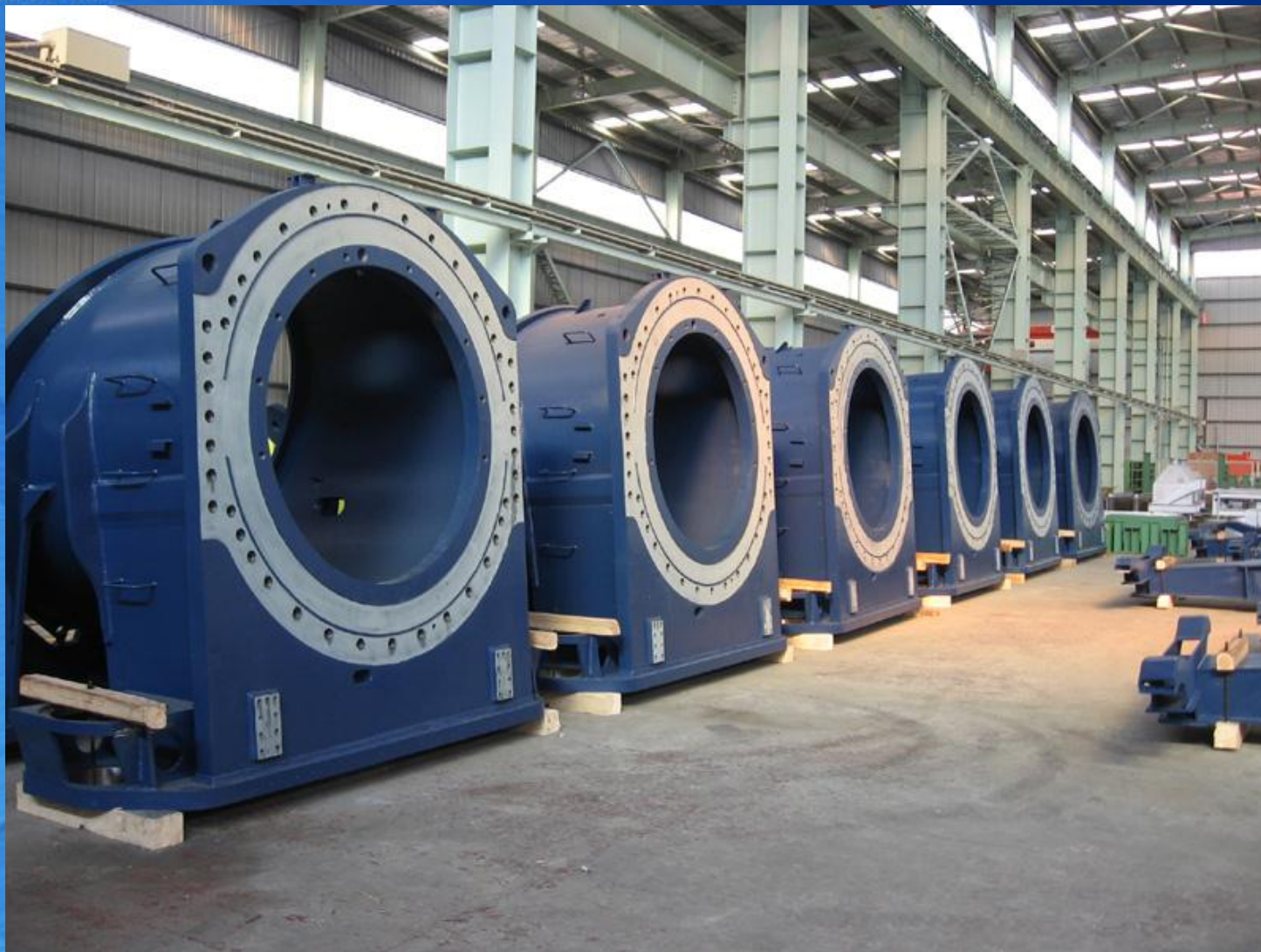
增速机机架（1500 kW 风力发电机） Frame of Speed-up machine（1500 kW Wind-driven generator）
