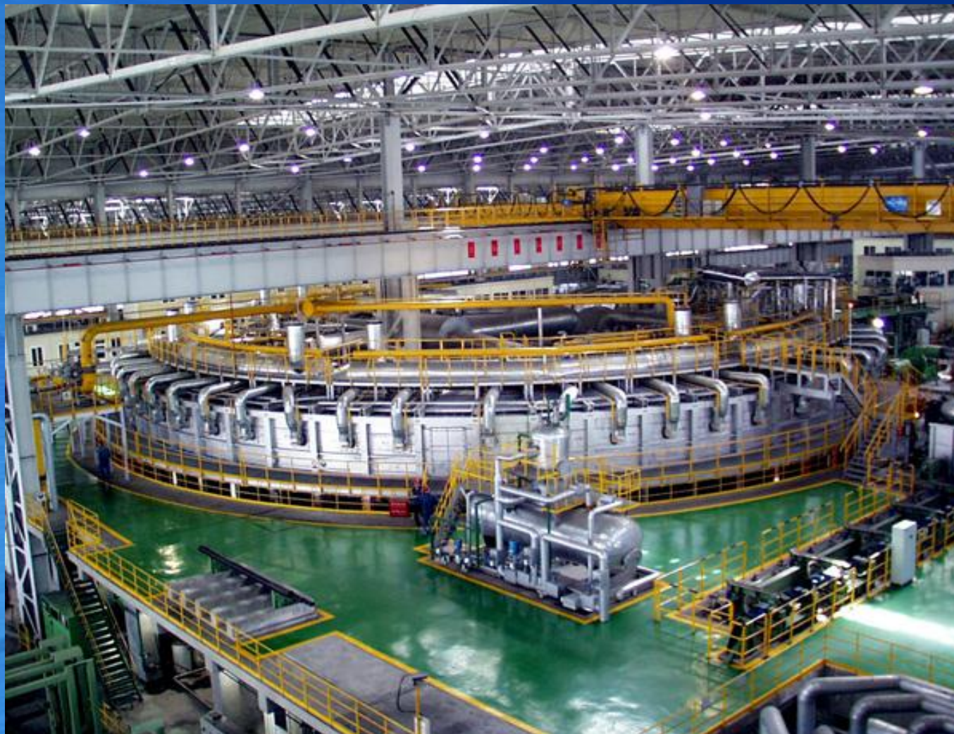
环形炉（直径35米） φ35m Rotary Hearth Furnace
