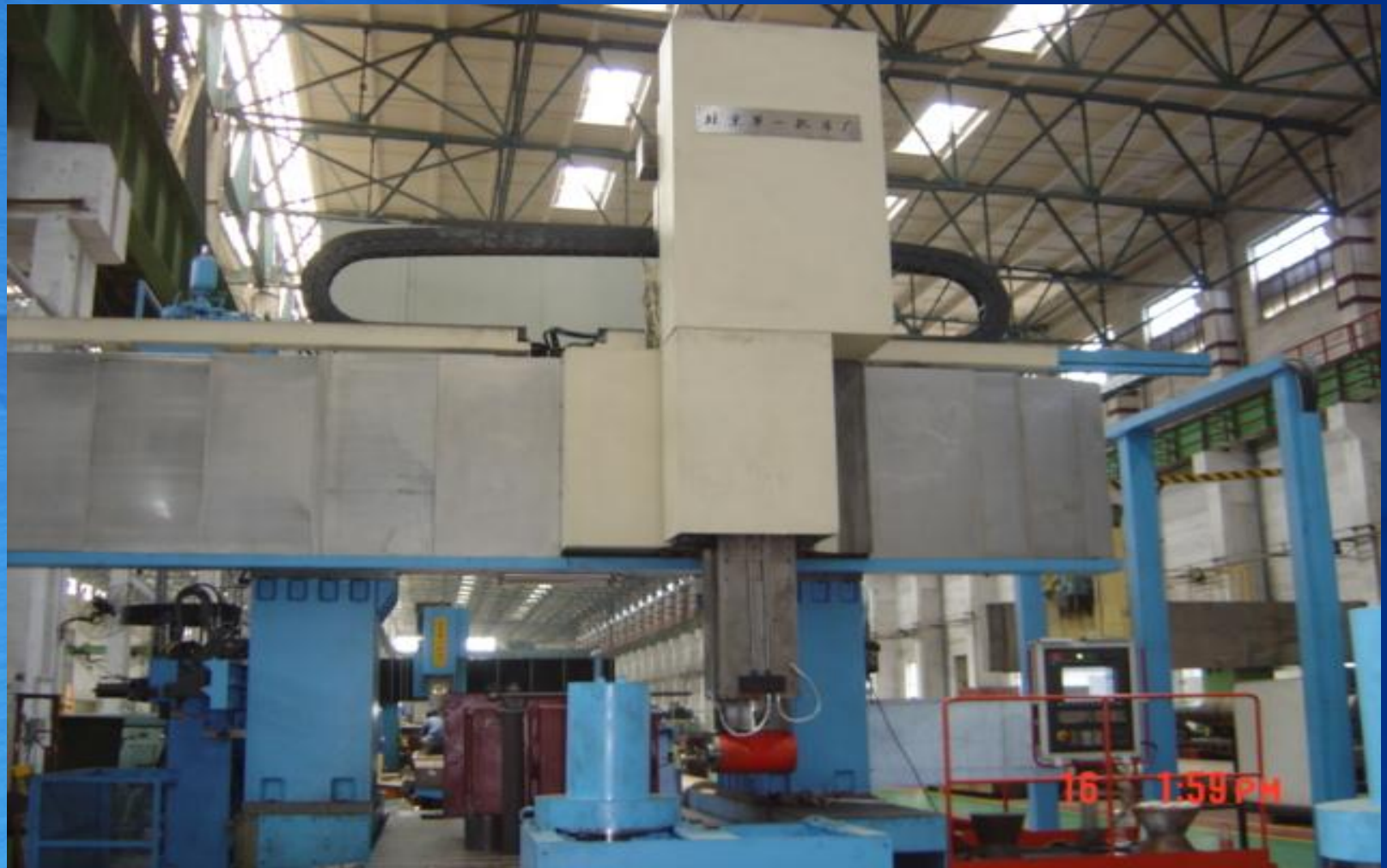
数控定梁桥式龙门加工中心 XHAE2720×60 CNC Planer Type Machining Center XHAE2720 X 60
