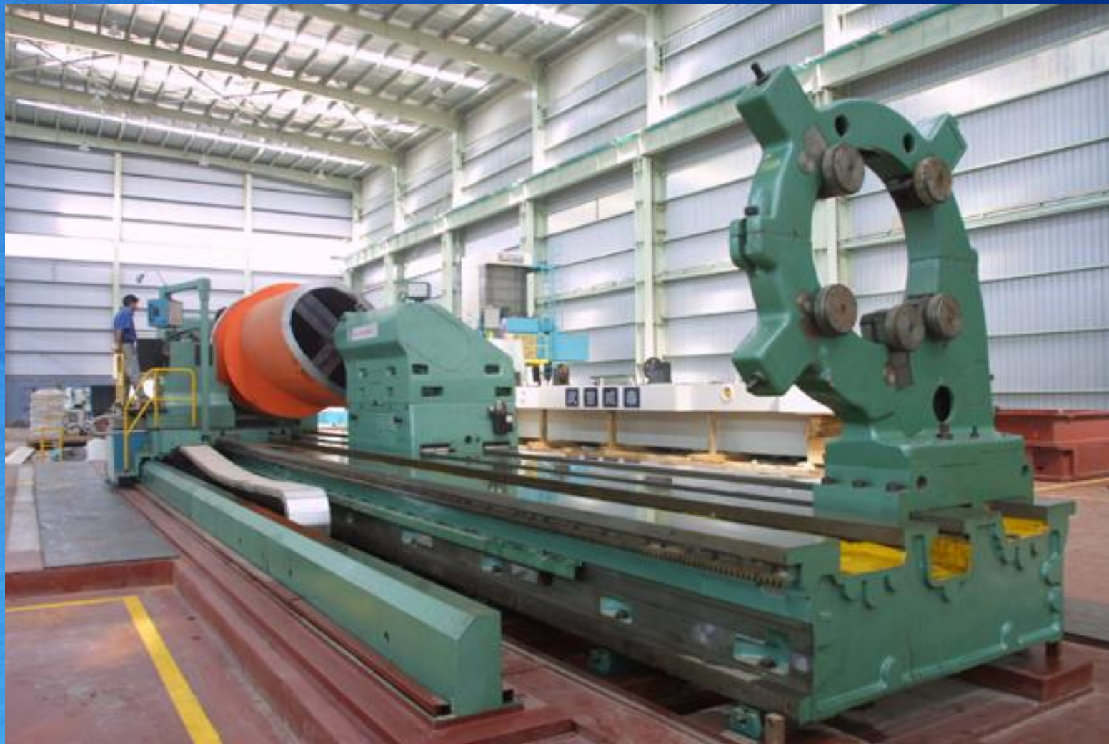
数控卧式车床 CQ61250 (最大加工直径:2500mm)
