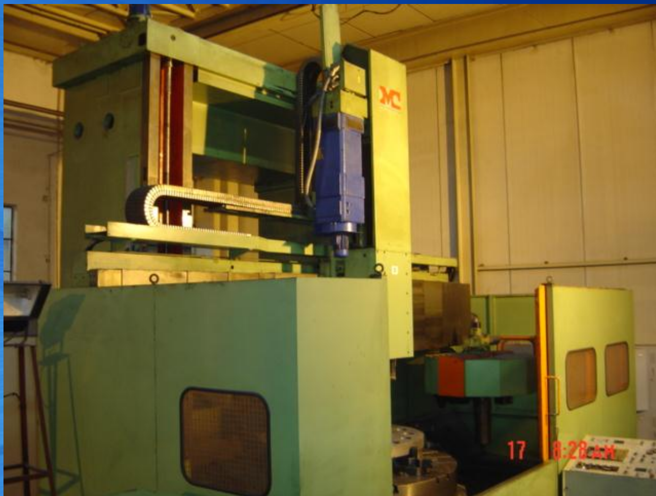
WETA 2.5m 数控立式车床 TG20/2500 (最大加工直径: 2.5 m)
