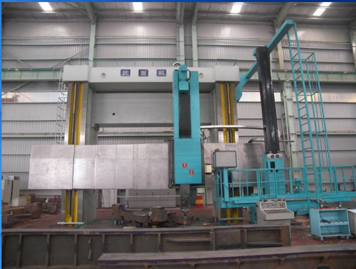
数控立式车床 CKX5263 (最大加工直径 6.3m )
