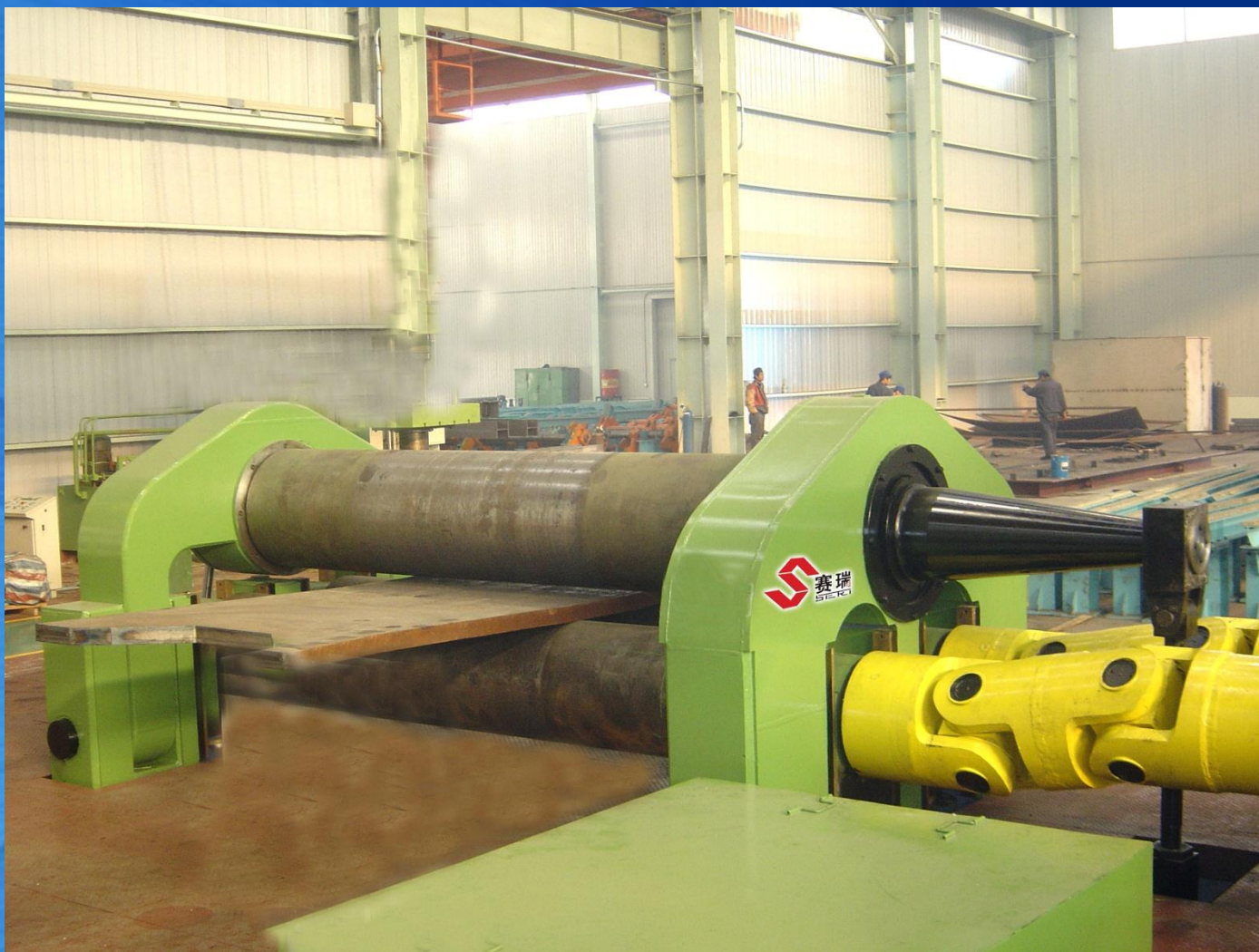
三辊卷板机（最大卷板厚度：100 mm）
