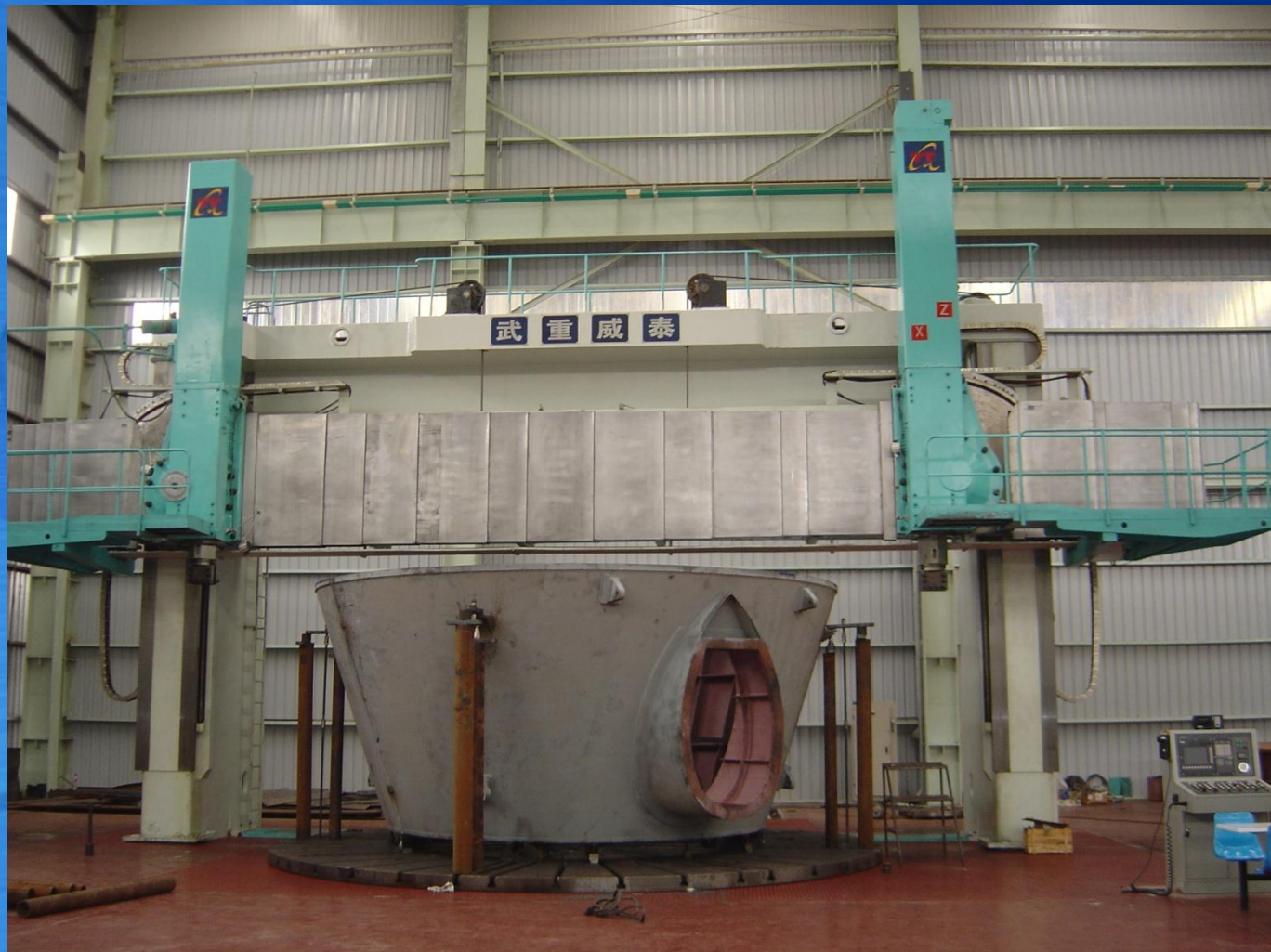
数控立式车床CK53100-1（最大加工直径:10m） CNC Vertical Lathe CK53100-1（Max diameter of machining: 10m）
