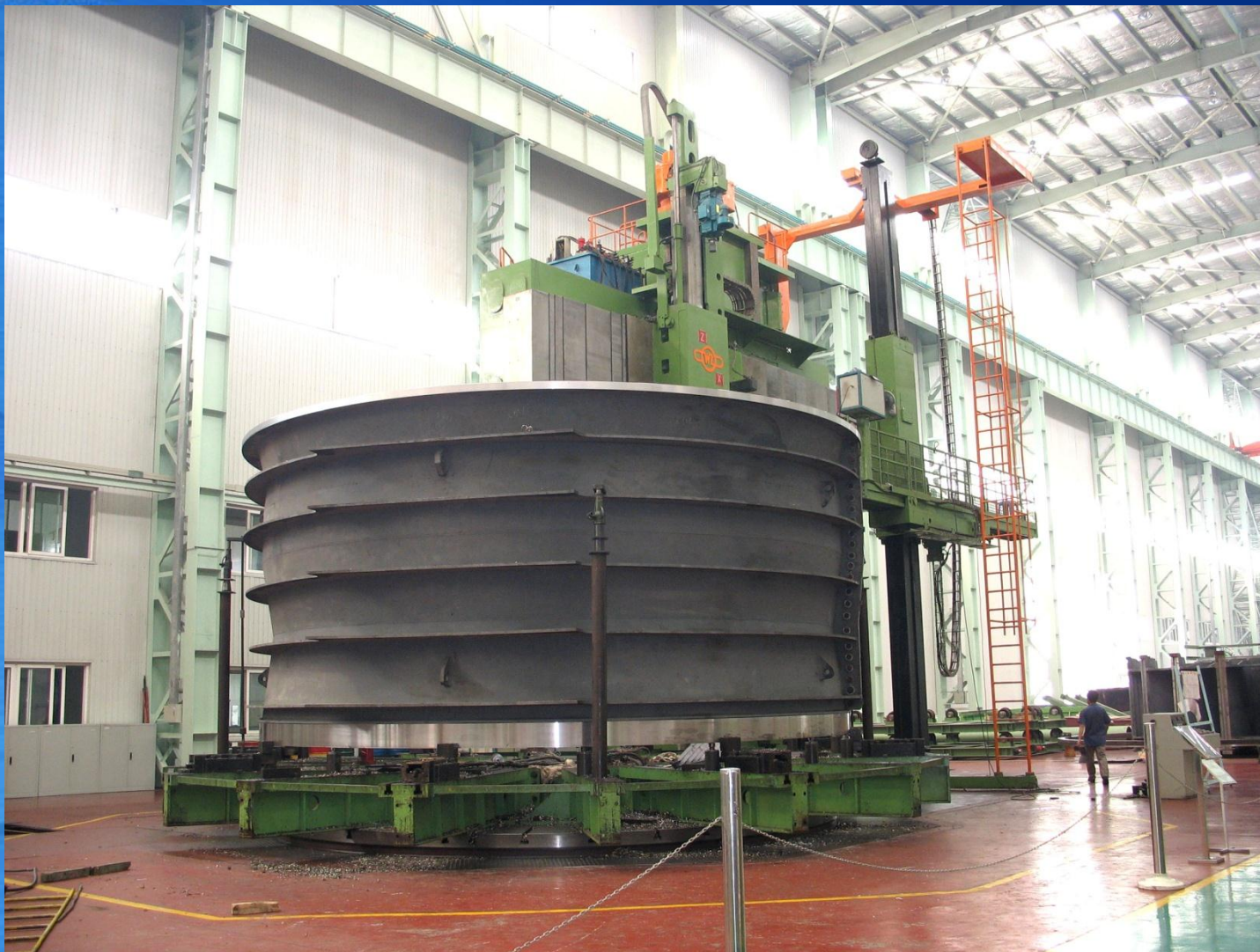
数控立式车床 CKX53150-1 （最大加工直径:15.8m） CNC Vertical Lathe CKX53150-1 （ Max diameter of machining:15.8m）
