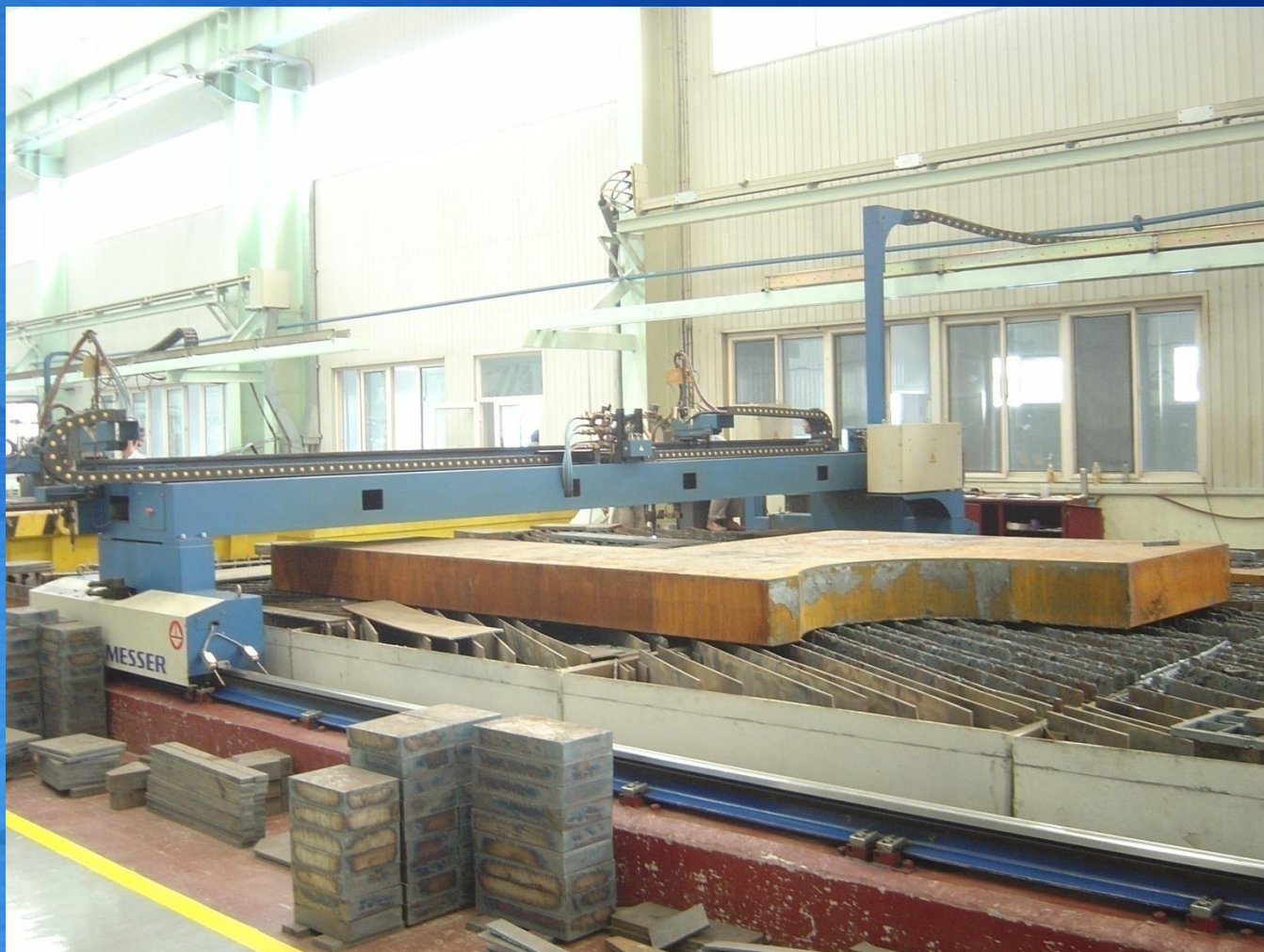
梅赛尔数控火焰切割机 MESSER CNC Flame Cutting Machine
