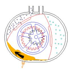
FIGURE 6 - IGNITION/POWER CYCLE
