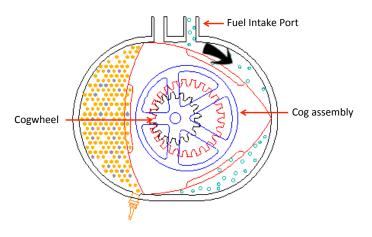
FIGURE 4 - INTAKE CYCLE
